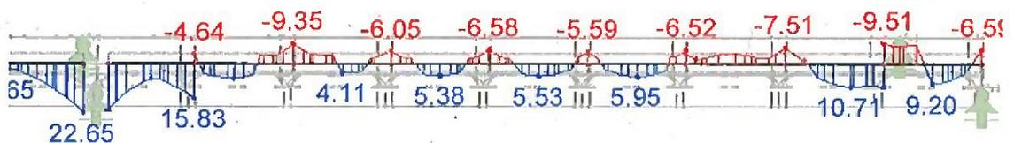
Selbst bei Berücksichtigung einer Erhöhung von 10 % im Stützenbereich C2 gemäß den Erkenntnissen aus Kapitel 2.2 ist die zulässige Spannung eingehalten:
