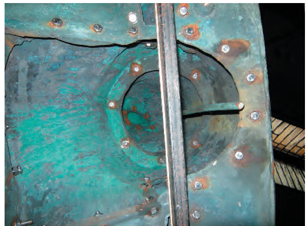
Abb. 28: Frau: Blick in die Innenkonstruktion: Die verrosteten Schrauben sind ausgetauscht worden. Die Schrauben, die zur Fixierung des Arms auf dem Kopf während des Lötens dienten wurden konserviert.
