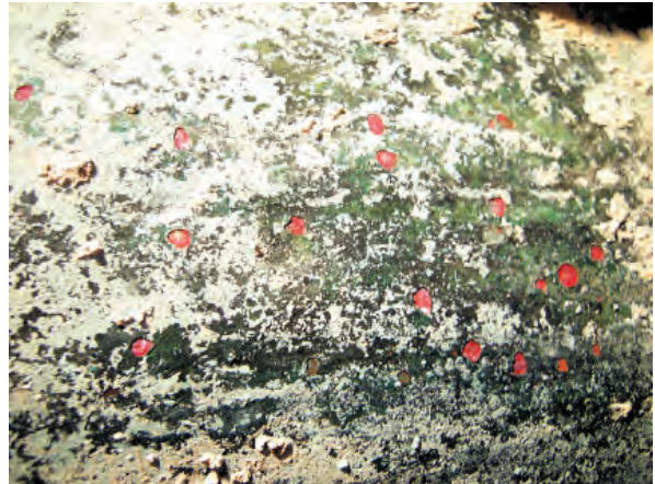
Abb. 19: In der Laboranalyse wurde die Zusammensetzung der "roten Nester" untersucht. Es handelt sich um Kupfer(I)oxid, \text{Cu}_2\text{O} (Cuprit)
