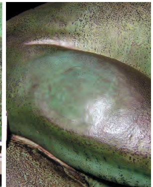
Abb. 7: Frau: Zustand nach der Bearbeitung. Der Metallflicken wurde neu patiniert und dem Farbton der Skulptur angeglichen.
