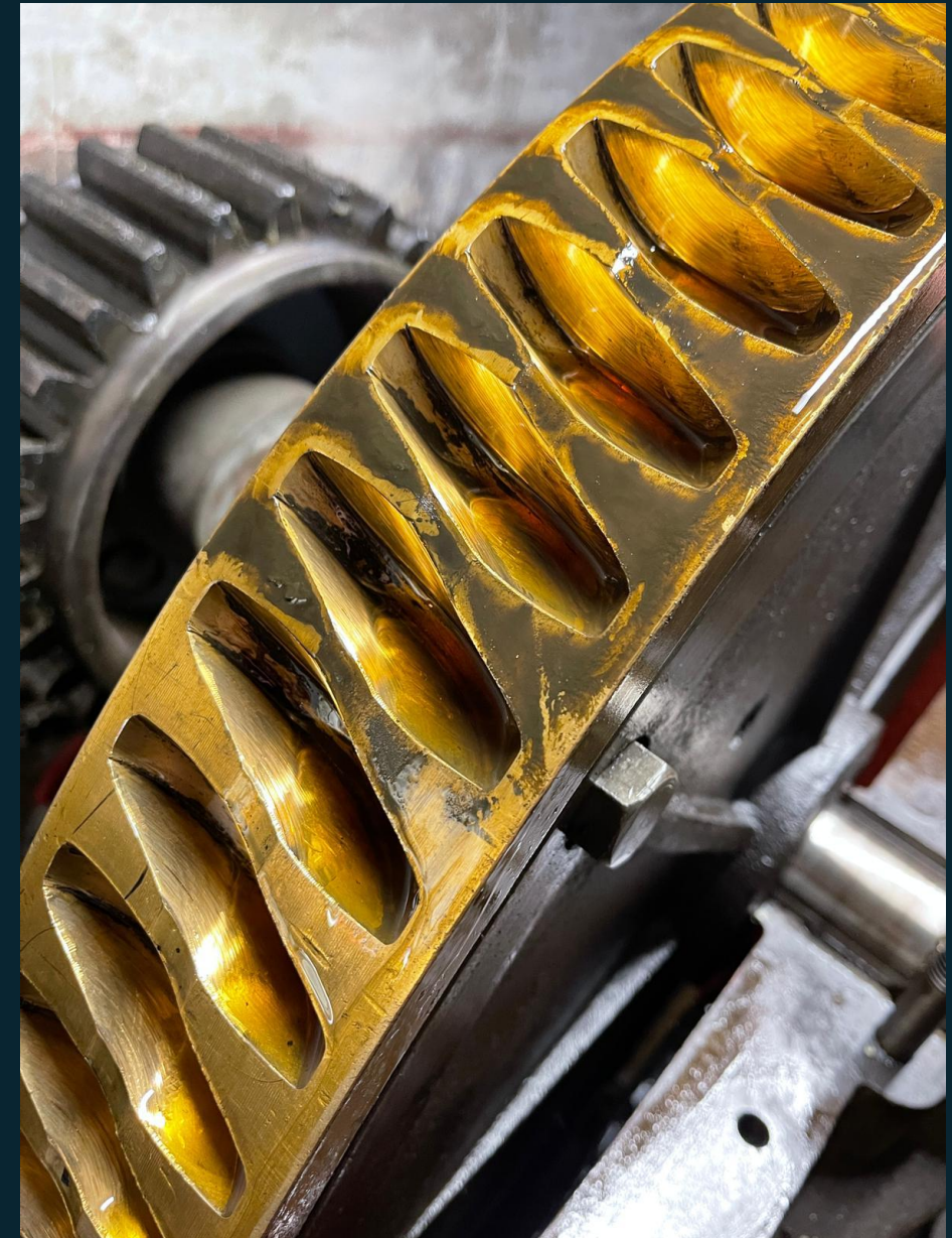
Schneckenrad aus Phosphorbronze, Wimmel und Landgraf (1908)
